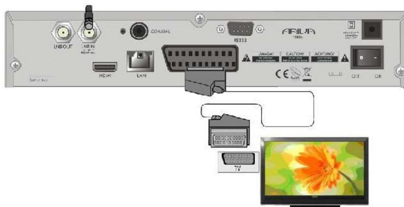
Rysunek 1. Schemat połączenia tunera satelitarnego z OTVC:
